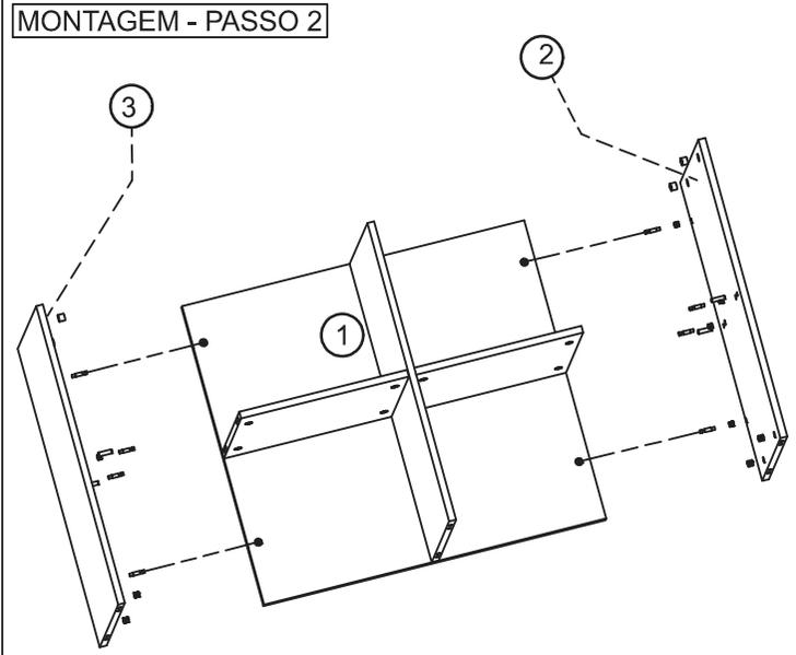
NA SEQUENCIA FAÇA A FIXAÇÃO DO FUNDO (1), LATERAL DIREITA (2) E A LATERAL ESQUERDA (3).
