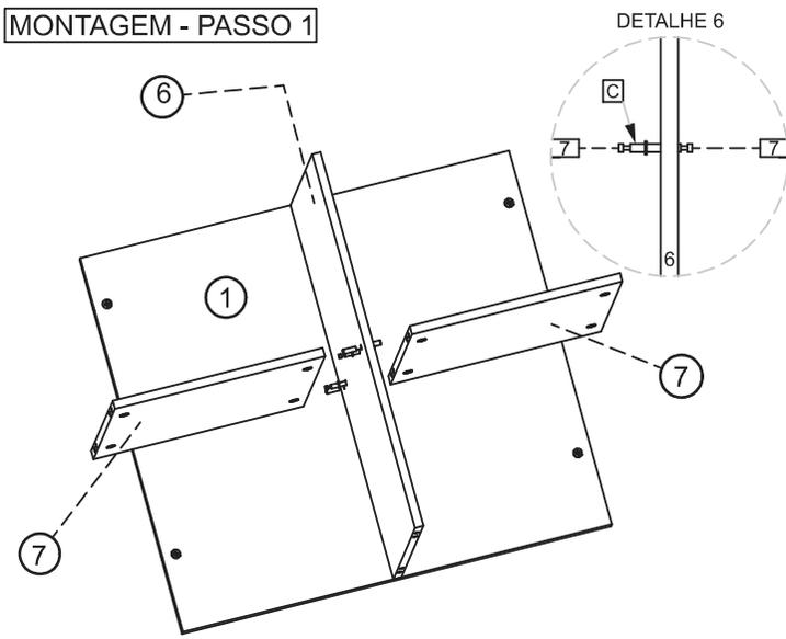
PARA FACILITAR A MONTAGEM DO MÓVEL POSICIONE O FUNDO NO CHÃO E SOBRE ELE, INICIE MONTANDO A "CRUZ" INTERNA ATRAVESSANDO O PINO DUPLO (C) NA DIVISORIA (6) CONFORME DETALHE 6, PARA QUE AS PRATELEIRAS (7) POSSAM SER FIXADAS.
